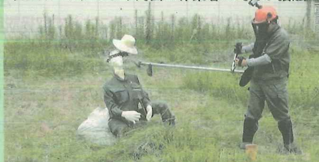
キックバックにより周囲の作業者に刈刃が接触
