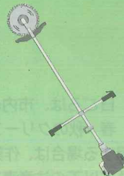
キックバックにより周囲の作業者に刈刃が接触
